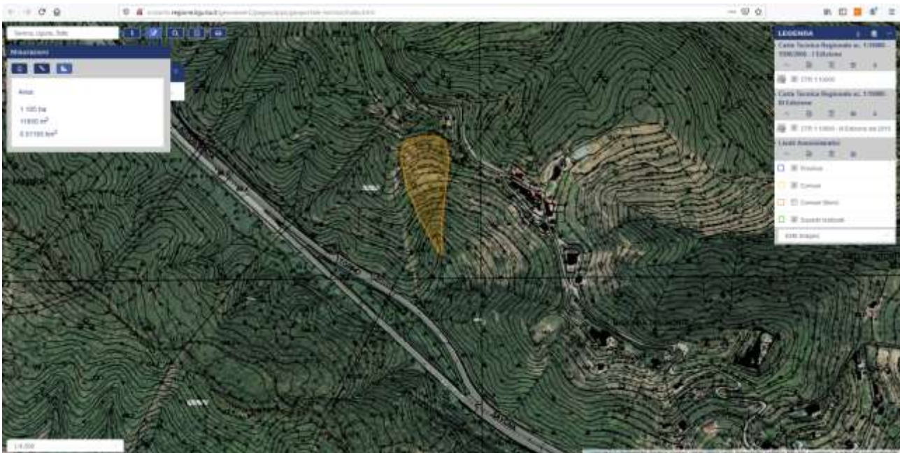
Figura 6 – Stima dell’area di distacco (in arancione) basata sulle immagini della frana reperite on line ed effettuata sul geoportale cartografico della Regione Liguria volume della massa mobilizzata stimata da Casagli,
